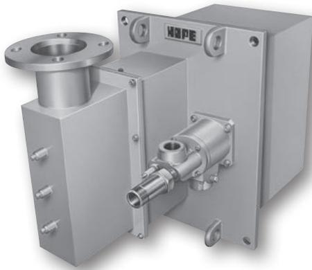
サイクルツインリジェネレイティブガスバーナーは、蓄熱室を備えた2台のバーナーに燃焼空気を交互に送り、対のバーナーで排熱を回収します。その熱を高温予熱空気として利用することにより、大幅な省エネルギーを実現させます。変成炉やベル炉、ピット炉等の熱処理炉に於いて熱効率を大幅に向上させることが可能です。
