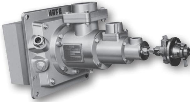
ガス、オイル共コンビネーションで燃焼できるミドルスピードバーナーです。炉内攪拌ファンを必要とせず炉内温度の均一化が図れます。
