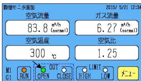
設定空気比より高い空気比で燃焼している場合、OPEN点灯・点滅 (緑色) します。燃料コントロールモータ開へ出力中状態
