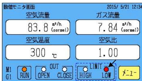
設定空気比より低い空気比で燃焼している状態で、燃料コントロールモータが限界の場合、LOW点灯（赤色）します。
