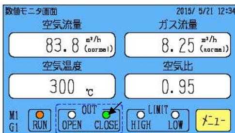
設定空気比より低い空気比で燃焼している場合、CLOSE点灯・点滅 (緑色) します。燃料コントロールモータ閉へ出力中状態
