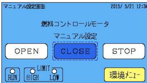
③. CLOSEボタン：燃料コントロールモータをクローズ出力します。
