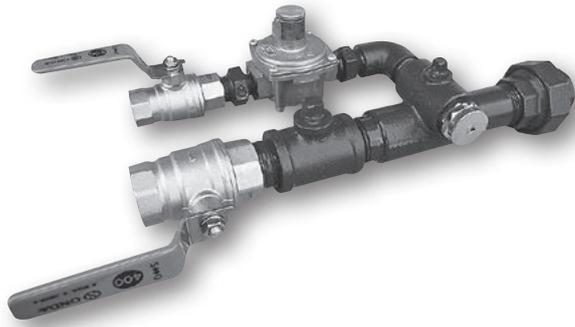
空気の運動エネルギーにてガスを比例吸引し、混合ガスをパイロットバーナーに供給するミキサーで、パイロットバーナーを1個又は数個接続して使用します。
