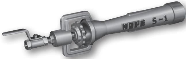
燃料ガスの噴射により大気中の空気を比例吸引し、完全混合状態のミックスガスをバーナーに供給する装置で各種プレミックスバーナーに使用されます。
