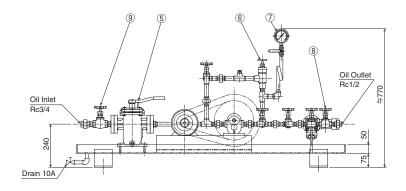
①ギアポンプ Gear Pump ②モータ Motor ③流量計 Flow Meter ④ストレーナー Strainer ⑤オイルストレ-Oil Strainer ⑥レタンバルブ Return Valve ⑦圧力計 Pressure Gauge ⑧ストップバルブ Stop Valve ⑨ストップバルブ Stop Valve
