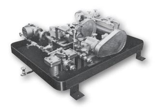
オイルポンプ、オイルストレーナー、オイルヒーター、流量計、圧力計、 レタンバルブ等をオイルパン上にユニット配管したものです。 現地での配 管作業が減少し、据付が簡単で、余分のスペースを必要としません。
