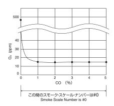
スモーク・スケール・ナンバーとは、バーナーの燃焼排ガスのスモーク(煤) 濃度を特定する為の基準です。
