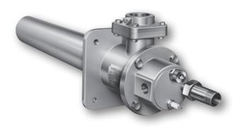
無酸化雰囲気炉用のラジアントチューブバーナーです。雰囲気ガス発生装置なしで排ガスを雰囲気ガスとして利用し、バーナー熱源と兼用します。CO数% CO2 を超微量の ppm オーダーに抑えます。無酸化雰囲気炉のコストパフォーマンスに貢献する非常に画期的なバーナーです。
