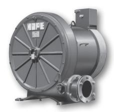
モーターを吸音材で内張りしたケーシングで覆い、空気吸引口をモー ター側に位置させ、モーター冷却用空気と兼用した斬新な構造となって おります。巻取式ロールフィルターの採用で、従来のサクションフィルター と違い清掃することなく汚れたら巻き取り、常にフィルター部を清潔にし てきれいな空気を送ることが出来ます。
