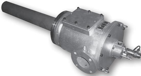
リジェネレイティブラジアントチューブバーナーは、蓄熱室を備えた2台のバーナーに燃焼空気を交互に送り、対のバーナーで排熱を回収します。その熱を高温予熱空気として利用することにより、大幅な省エネルギーを実現させます。
