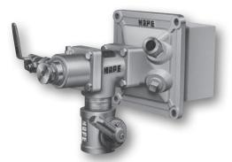
ガス量の調整バルブが一体化されており、均圧弁やバルブの連動方式による比例制御、又は広範囲のターンダウンを必要とする場合には最適です。
