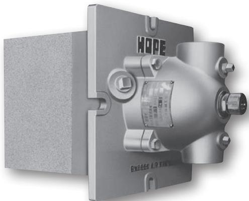
ノズルミックスタイプのバーナーで、過剰空気でも非常に安定した燃焼が得られ、高速燃焼により炉内を攪拌し均一加熱ができます。またターンドアウン比が大きく低温域まで幅広い温度制御が可能です。
