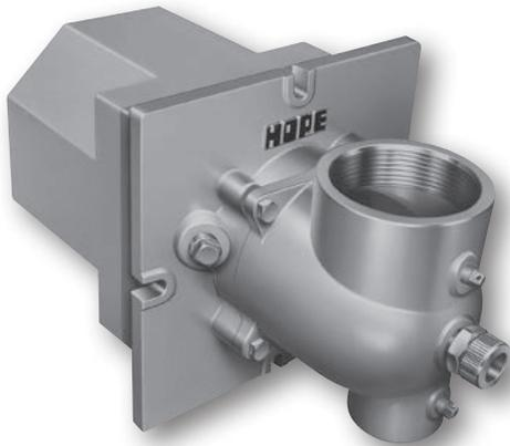
自己再循環により燃焼排ガスを火炎内にもどし火炎温度を下げ NOx の発生を抑制する。
